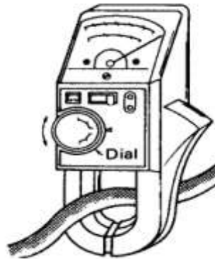
Hình 2.8. Kiểm tra dòng điện hàn bằng ampe kìm
