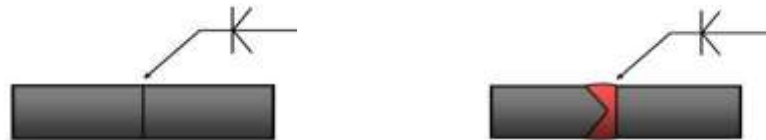
Mối hàn giáp mối vát mép chữ nửa chữ V kép, hàn hai phía
