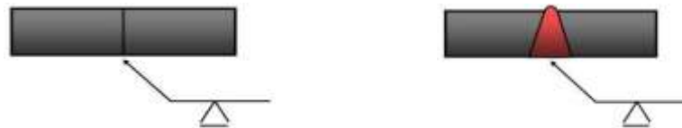
Mối hàn giáp mối vát mép chữ V đơn, hàn một phía, bề mặt bằng
