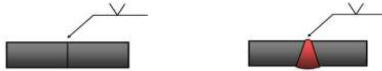
Mối hàn giáp mối vát mép chữ V đơn, hàn một phía
