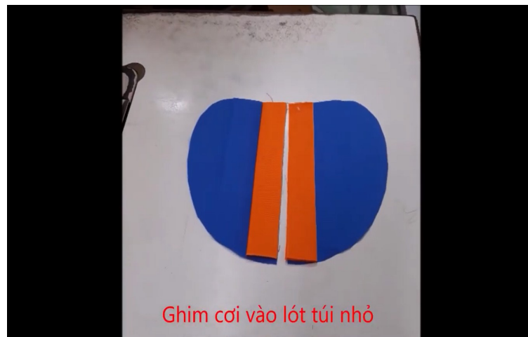
Hình 3.4. Hình may ghim coi túi vào lót túi và đắp túi
