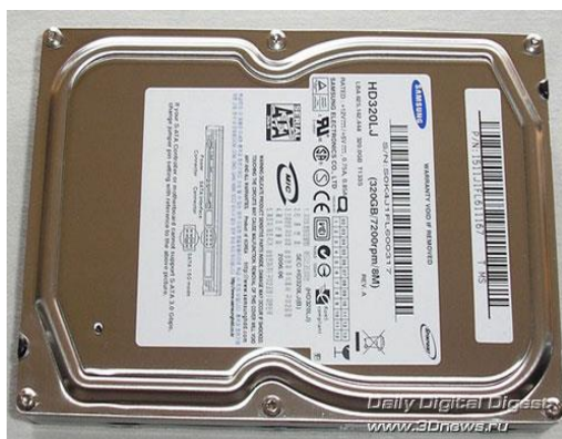
HDD gắn trong Desktop Kích thước 3,5 inch
