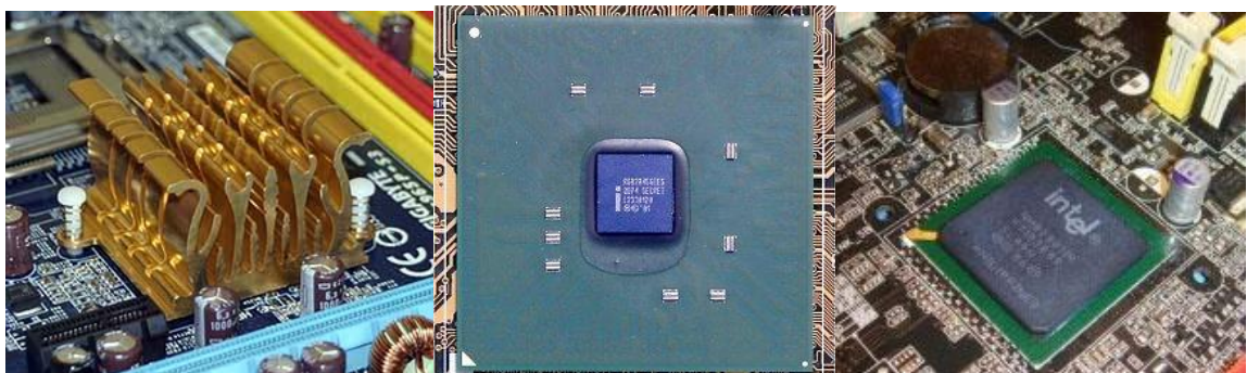
Tải nhiệt chip cầu bắc
