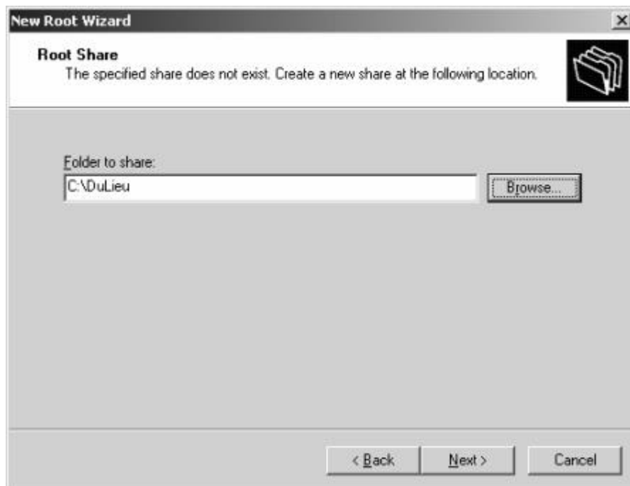
Hình 6.18 Khai báo tên thư mục chia sẻ gốc của hệ thống DFS.
